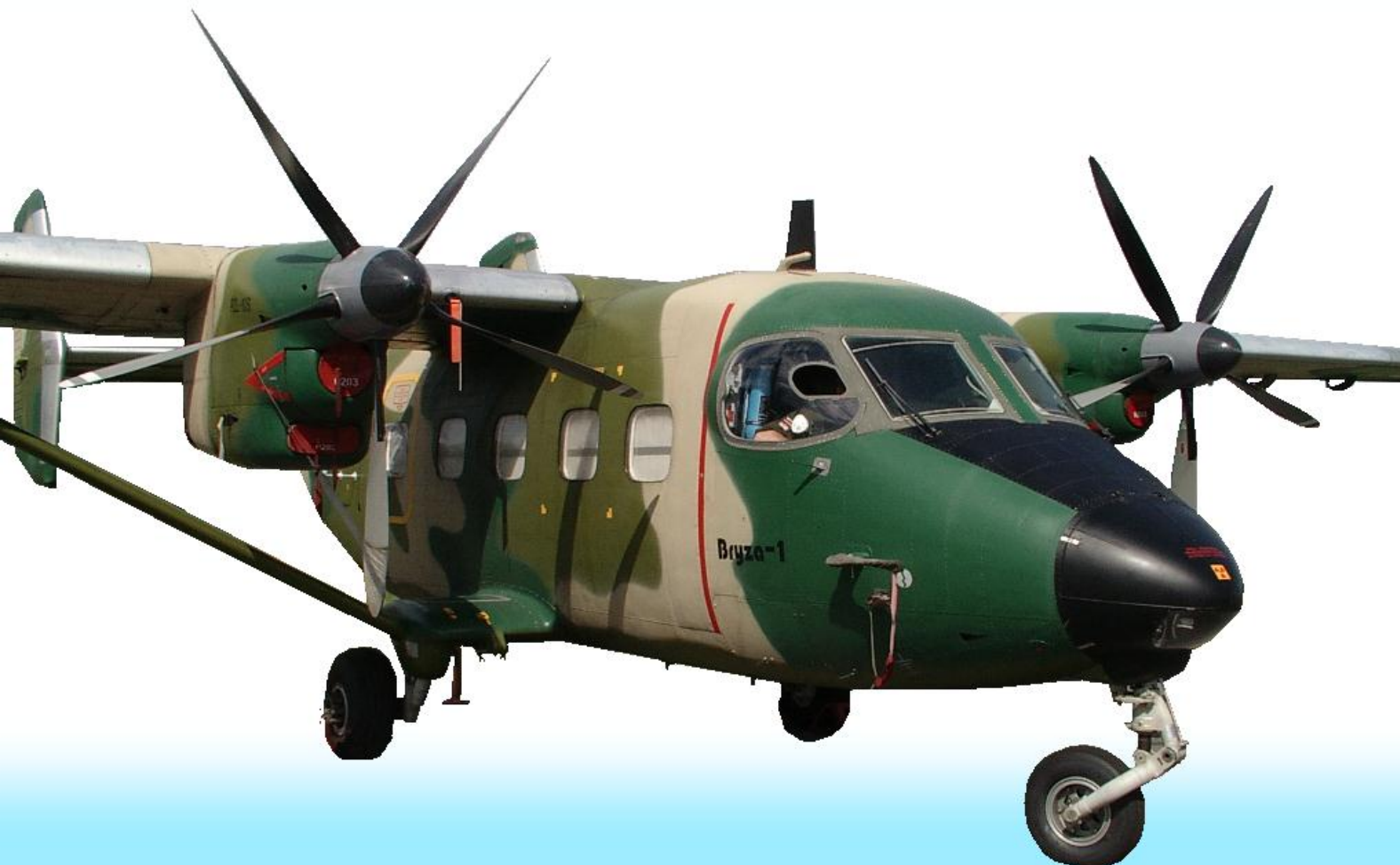
Samolot PZL M28B Bryza TD napędzany dwoma silnikami TWD-10B/PZL-10S
